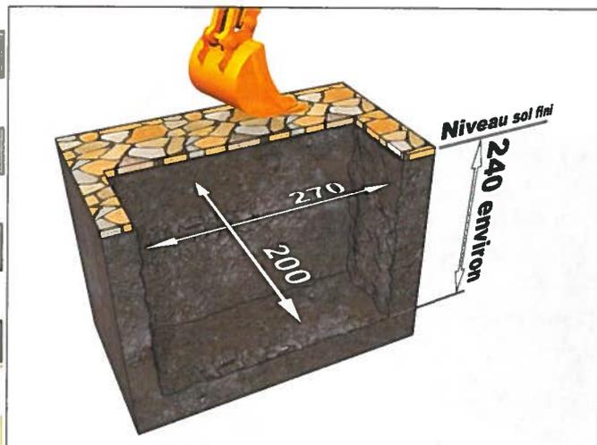
**b.** Déposer du granulat en fond de fosse. Tirer de niveau le granulat en gardant la côte de hauteur /sol fini de **198 cm**. Le mobilier dépasse de 40 mm environ du sol fini pour éviter les infiltrations importantes d'eau de pluie.
